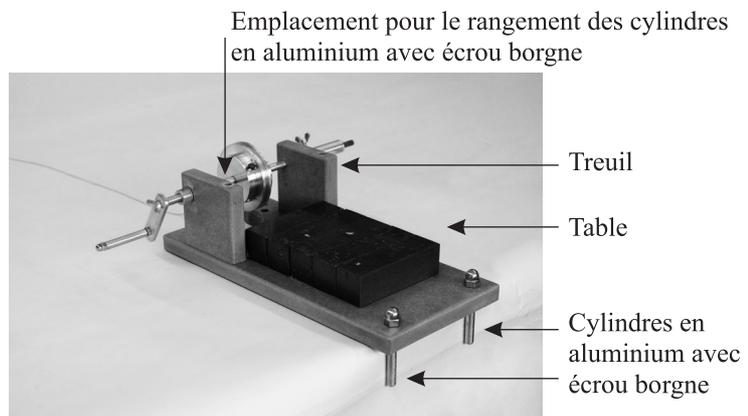
2. Placer le treuil à l'extrémité d'une table ayant une longueur minimale de 1,5 m en veillant à ce que les cylindres en aluminium soient placés contre le bord vertical de la table (voir photo ci-avant). Pour faciliter le rangement, les tiges sont glissées dans le support.
